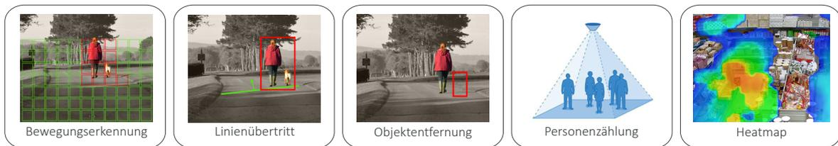
Bei der Video-Content-Analyse wird versucht, Objekte im Bild vom Hintergrund zu unterscheiden um diese anschließend zu analysieren. Dadurch können Fehlauflösungen stark reduziert werden.
